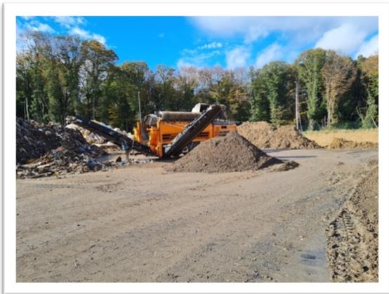
Abbildung 69: Trommelsieb, Trennen der Mineralik vom Abfall beim AWZ (Foto: AWB)
