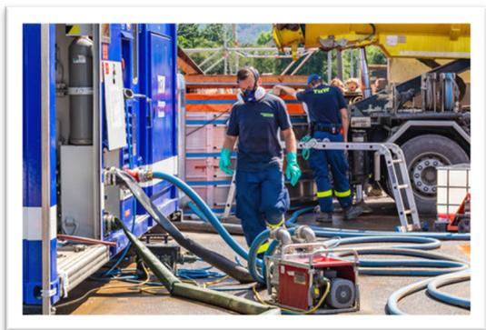
Abbildung 50: Zentrale Öl-Sammel- und Separationsstelle des THW in Sinzig, hier aktiv bei Aufbereitung von Öl-Wassergemischen (Foto THW)
