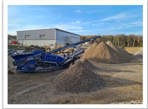
Abbildung 70: Aufbereitung von Mineralik und Schutt im AWZ (Foto: AWB)
