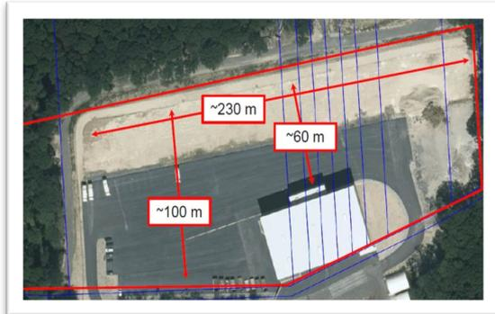
Abbildung 9: Abdeckungsbereich der Infrarotüberwachung für den Brandschutz (PYROSmart®) auf dem Gelände des AWB (Foto: AWB)
