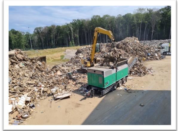
Abbildung 24: Beladung Shredder Komtech Terminator 5000 (Foto: AWB)
