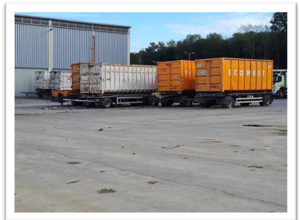
Abbildung 26: Anhänger für den Containertransport (Foto: AWB)
