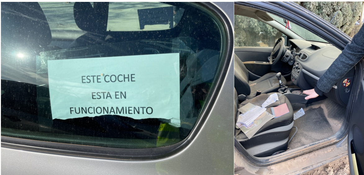
Fig. 14 Inscripción «Este coche funciona» (izquierda) y estimación de la capacidad de funcionamiento de un coche, siempre que el nivel máximo durante la inundación se mantuviera por debajo del salpicadero.
