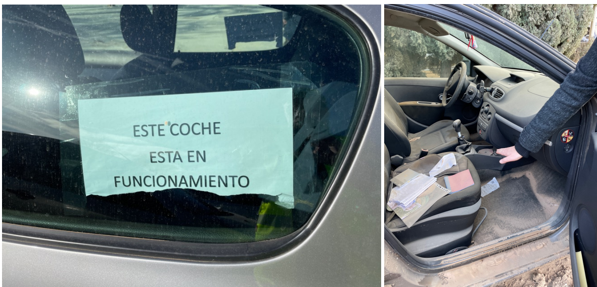
Abb. 14 Aufschrift „Dieses Auto funktioniert“ (links) und Abschätzung der Funktionsfähigkeit eines Autos, sofern der Höchststand bei der Flut unterhalb des Armaturenbrettes blieb
